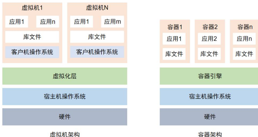
图 1: 虚拟机与容器架构对比图
